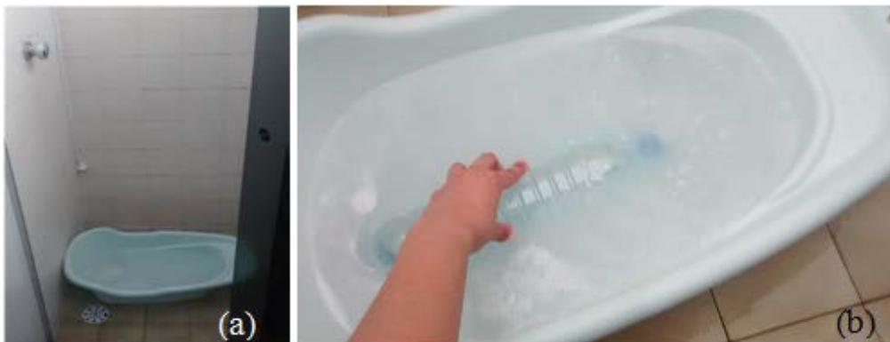
Figura 1: Reservatório para captação da água de banho (a) e coleta de amostras (b).
